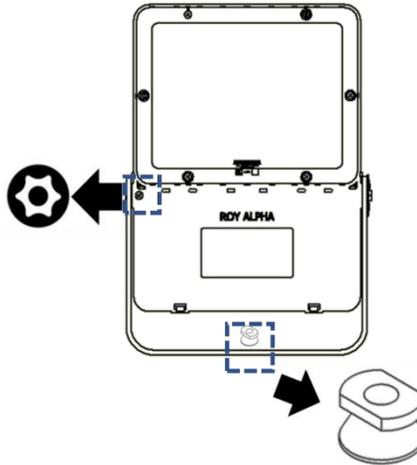
**Tuerca cónica de cabeza fusible** para tornillo de Ø3/8 UNC con el fin de asegurar la U al sistema de fijación. Asegúrese de fijar la posición adecuada antes de accionar la tuerca.
