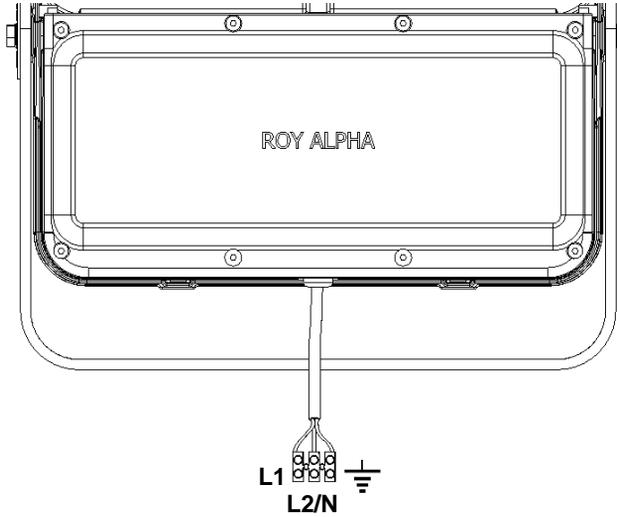
Ver etiqueta de identificación antes de conectar a línea; verificar que la tensión de alimentación sea el requerido por esta luminaria, verificar clasificación eléctrica. Verifique encendido, reporte a fabrica cualquier eventualidad.
