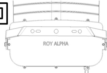
Ver etiqueta de identificación antes de conectar a línea; verificar que la tensión de alimentación sea el requerido por esta luminaria, verificar clasificación eléctrica (A/clase I) (B/clase II). Verifique encendido, reporte a fabrica cualquier eventualidad.
